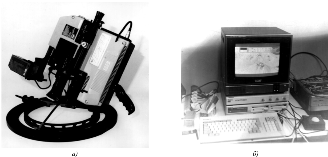
Рис. 3. Интерактивная микропроцессорная видеоспектрометрическая система «Гемма2-видео»: а) оптический приемный блок; б) бортовой информационно-вычислительный комплекс
